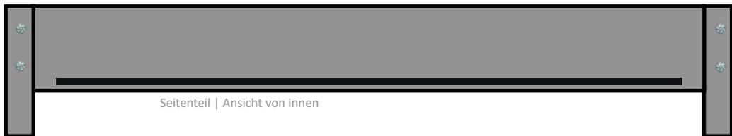
Anschließend werden die Kopf- und Fußteile mit den Seitenteilen verbunden. Dazu sind die Exzentergehäuse mit dem Schlüssel gleichmäßig anzuziehen. *Hierbei ist etwas mehr Kraft notwendig, bis die Einfachbolzen greifen.*
