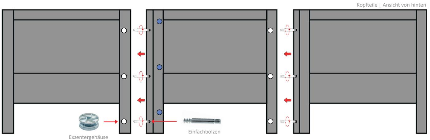
Anschließend werden die Kopfteile verbunden. Dazu sind die Exzentergehäuse mit dem Schlüssel gleichmäßig anzuziehen. Hierbei ist etwas mehr Kraft notwendig, bis die Einfachbolzen greifen.
