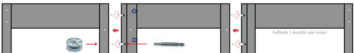
Anschließend werden die Fußteile verbunden. Dazu sind die Exzentergehäuse mit dem Schlüssel gleichmäßig anzuziehen.
