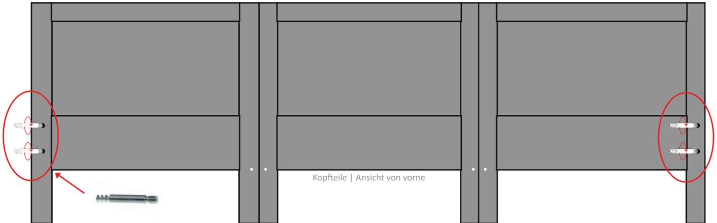
Die 8 Exzentergehäuse in die Bohrungen bei den Seitenteilen einsetzen. Der Pfeil beim Exzentergehäuse muss zur Bohrung ausgerichtet werden, damit die Einfachbolzen greifen können.
